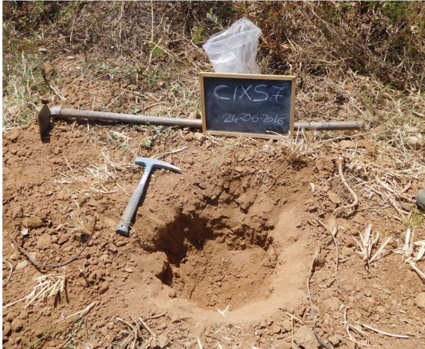
Figura 21 - Prelievo del campione inalterato sotto la prima porzione di suolo
