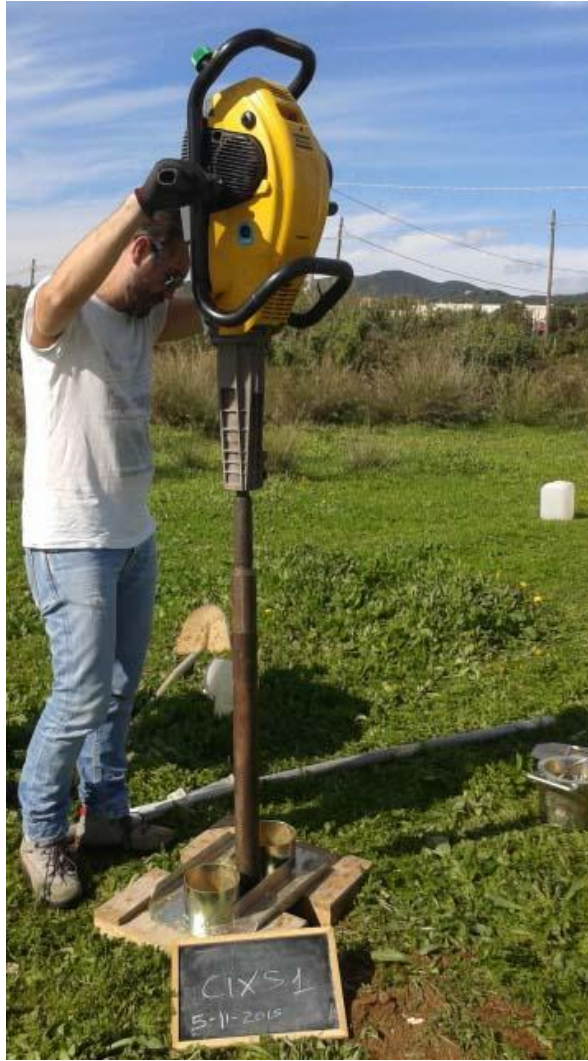
Figura 20 - Prelievo del campione inalterato con la perforatrice Cobra Atlas Copco
