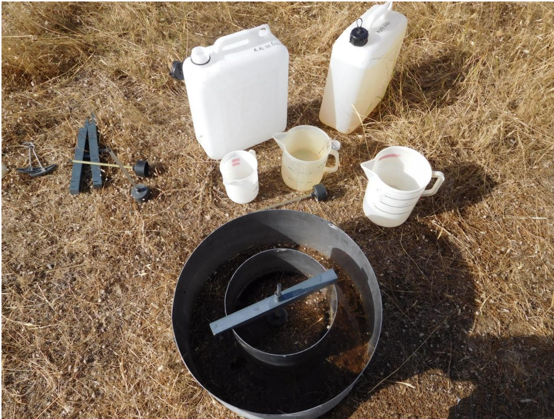
Figura 26 - Prove di infiltrazione
