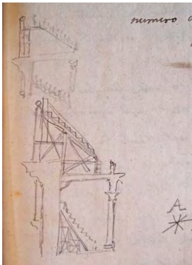
104 e 105. Efisio Luigi Tocco, costruzione di un ordine di gradinate in legno collocate sulla sommità dell'Anfiteatro Flavio, da ASCapRoma, Miscellanea famiglie e persone, Carte Tocco, Busta 27, Autorizzazione QD 56 del 4-1-2016.
