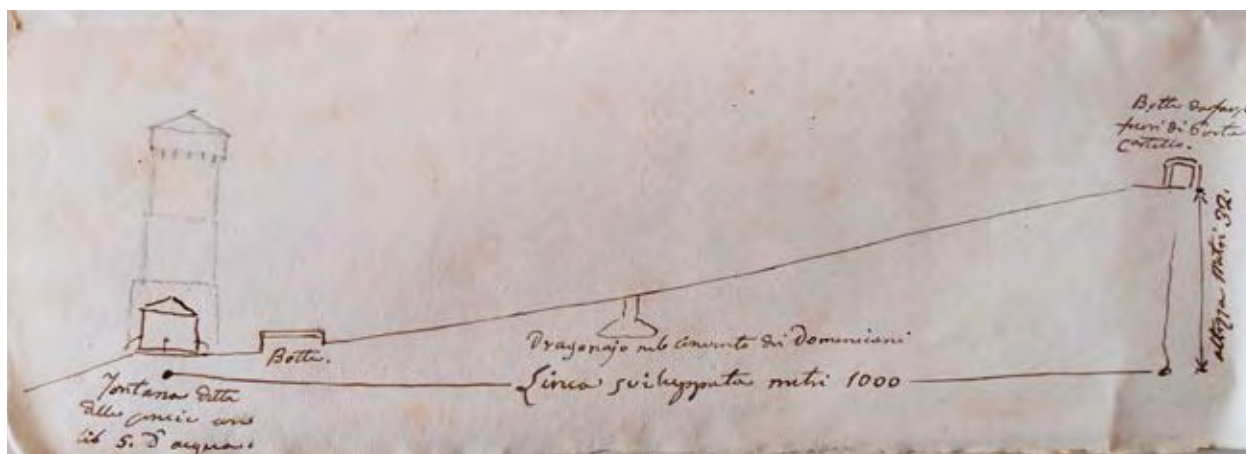
80. Efsio Luigi Tocco, Schema quotato in sezione tra la Fontana le Concie e la Botte di Castello, con la posizione della Dragonaia, condotto d'acqua sotterraneo esistente, Archivio Storico Capitolino, Miscellanea famiglie e persone, Carte Tocco, Busta 28, Autorizzazione QD 56 del 4-1-2016.
