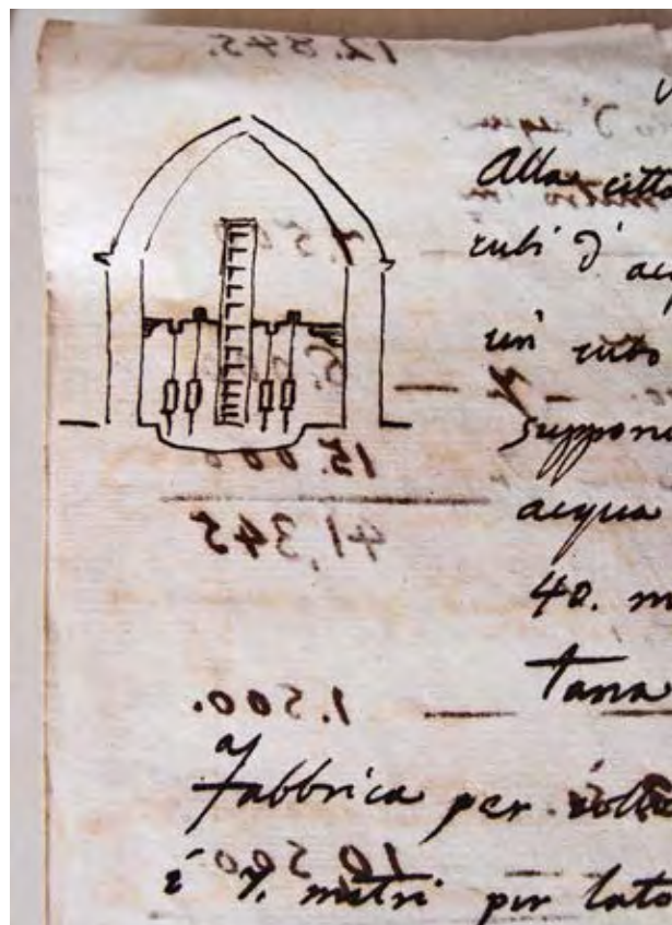
69 Efsio Luigi Tocco. Studi per l'acquedotto di Sassari. Edificio contenente una ruota e un albero a camme. Archivio Storico Capitolino, Miscellanea famiglie e persone, Carte Tocco, Busta 28, Autorizzazione QD 56 del 4-1-2016.
