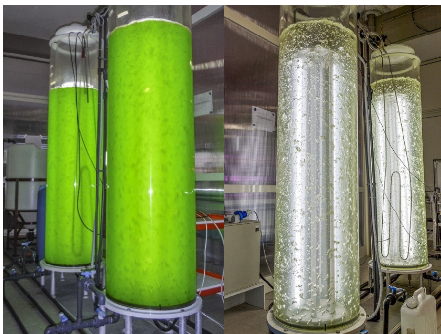
Figura 5.5: Fotobioreattori con biomassa algale in fase di crescita (Sn) e in fase di disinfezione con ipoclorito di sodio (Dx) - foto G. Saiu
