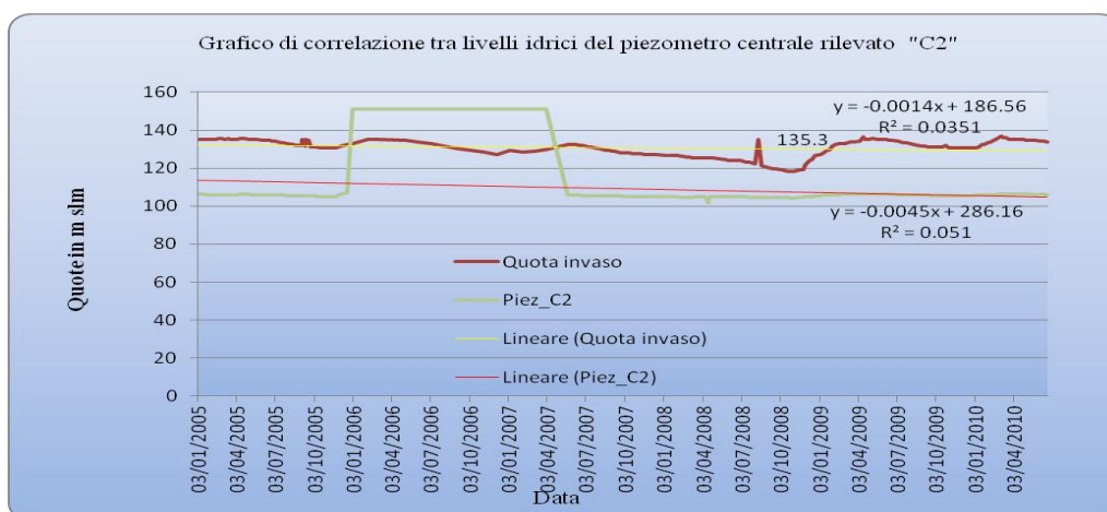
Fig. 9.30– Correlazione tra livello di invaso e livelli idrici del piezometro C2 centrale del coprpo diga con indice di correlazione 0.10 - correlazione debole .
