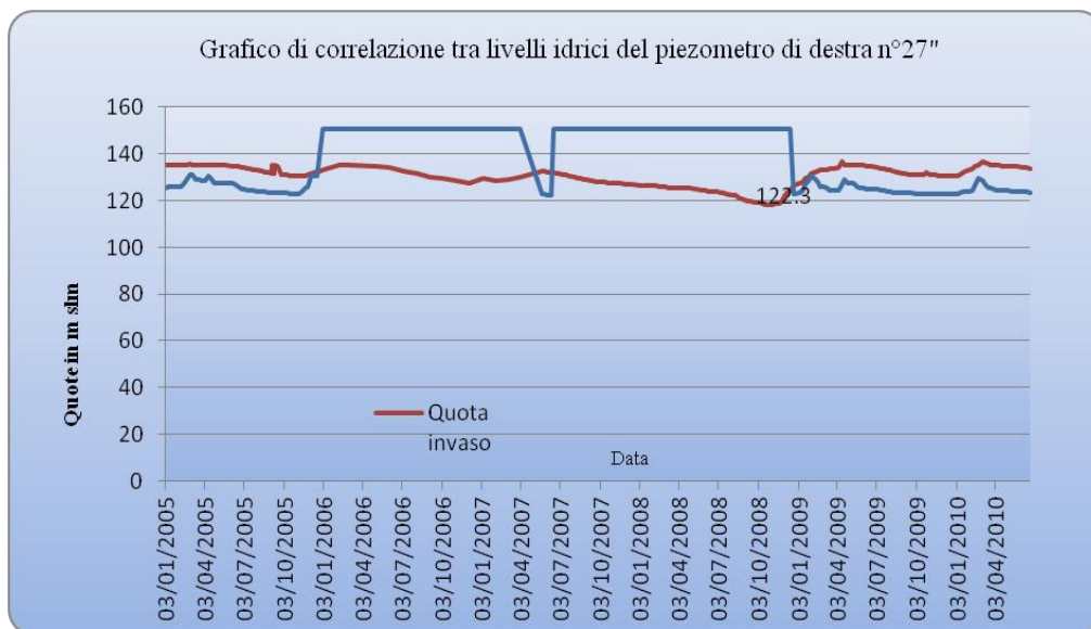
Fig. 9.60– Correlazione tra livello di invaso e livelli idrici del piezometro 27 del fianco destro con indice di correlazione 0.06 - correlazione debole .
