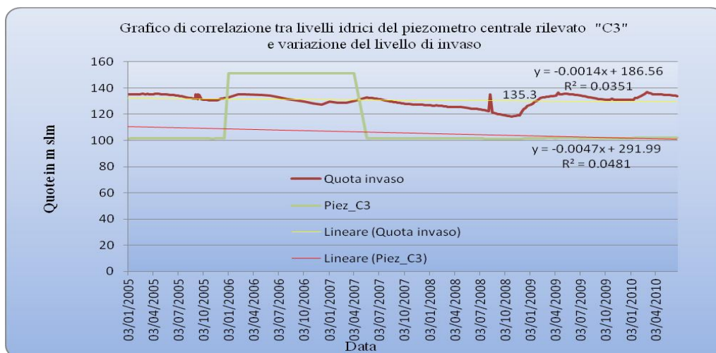
Fig. 9.29 – Correlazione tra livello di invaso e livelli idrici del piezometro C3 centrale del coprpo diga con indice di correlazione 0.15 - correlazione debole .
