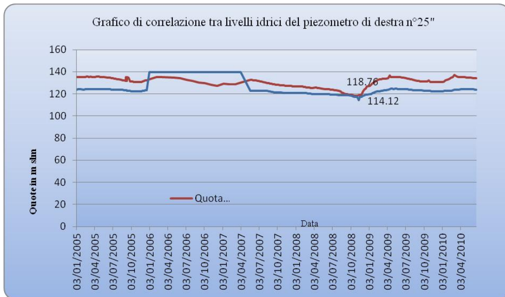
Fig. 9.59– Correlazione tra livello di invaso e livelli idrici del piezometro 25 del fianco destro con indice di correlazione 0.40 - correlazione moderata .
