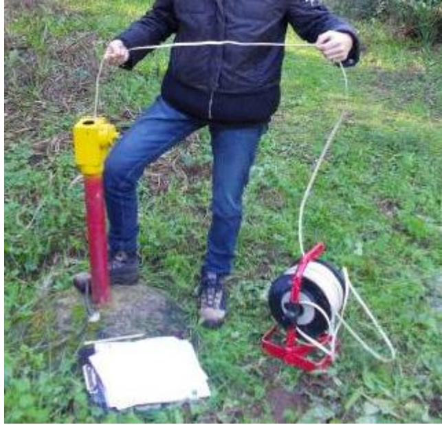
Fig.11.13 – Misura della soggiacenza nel piezometro n°8.
