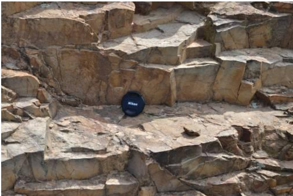
Fig.4.2 –Stazione di rilievo geomeccanico ST1, ben evidente le diverse direzioni dei piani.
