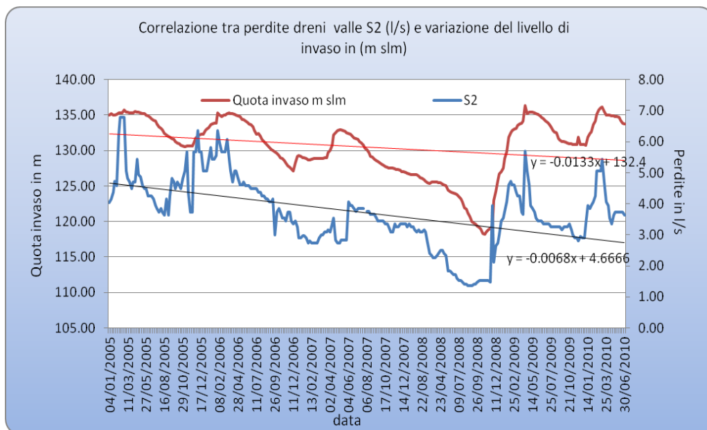
Fig. 9.10– Grafico di correlazione tra le perdite misurate nel dreno di valle sinistro S2 e la variazione del livello di invaso.
