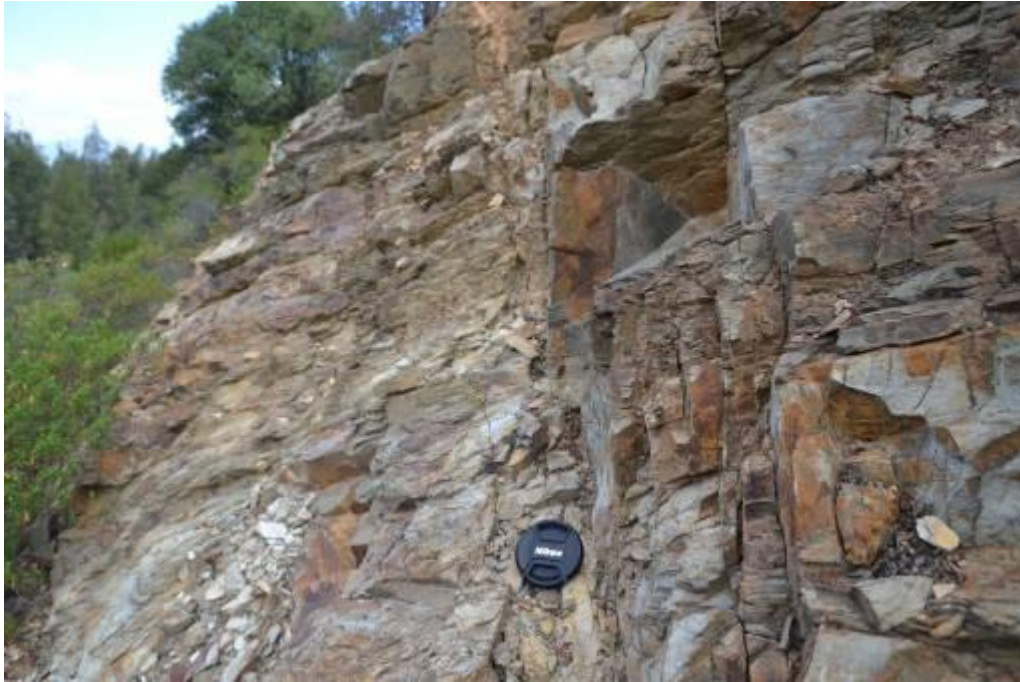
Fig.4.3 –Stazione di rilievo geomeccanico ST2, ben evidente le l'intensa fratturazione.
