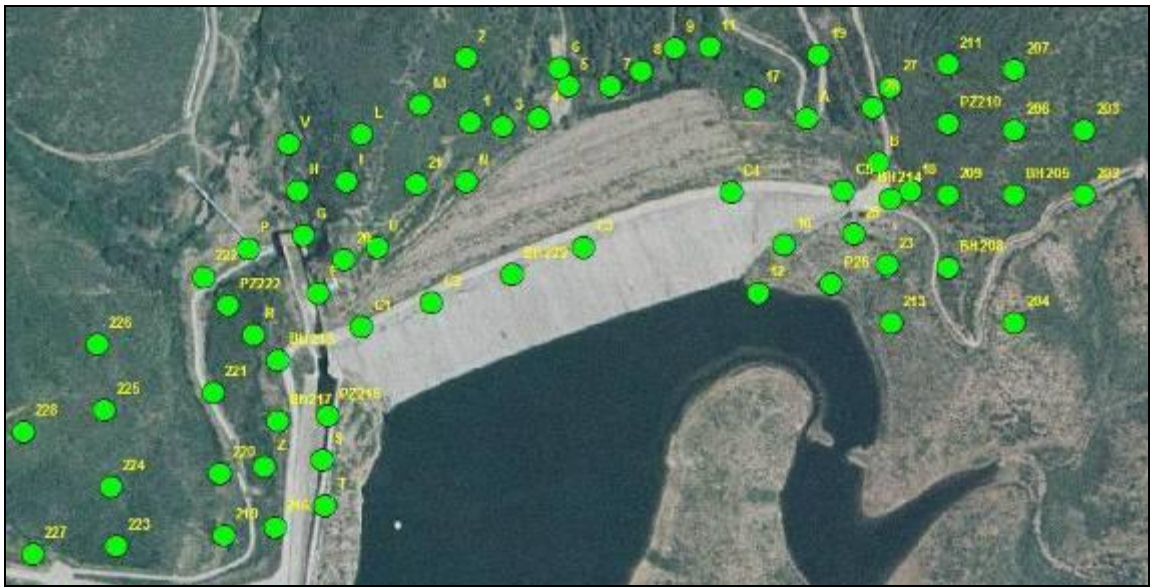
Fig.8.2 – Localizzazione di piezometri esterni allo sbarramento, su ortofoto dell'anno2006.
