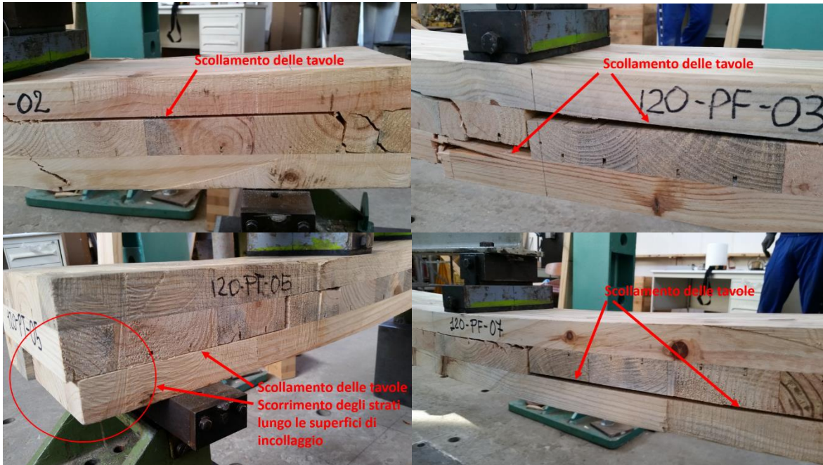
Figura 4.2.13 Difetti di incollaggio nei pannelli a tre strati da 40 mm
