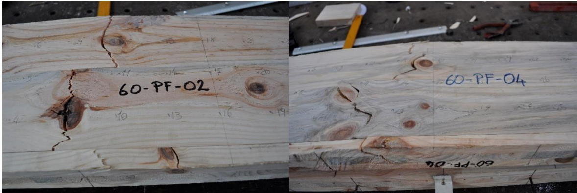
Figura 4.2.10 Rotture di pannelli omogenei di Pino Marittimo a 3 strati
