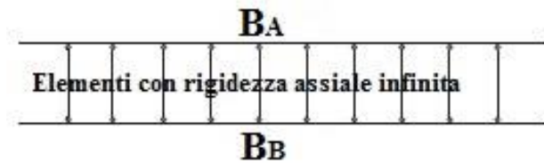
Figura 4.3.4 Schematizzazione del principio del Shear Analogy
