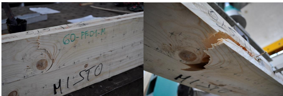
Figura 4.2.8 rottura per trazione delle tavole - Pannello Mistto Abete Pino
