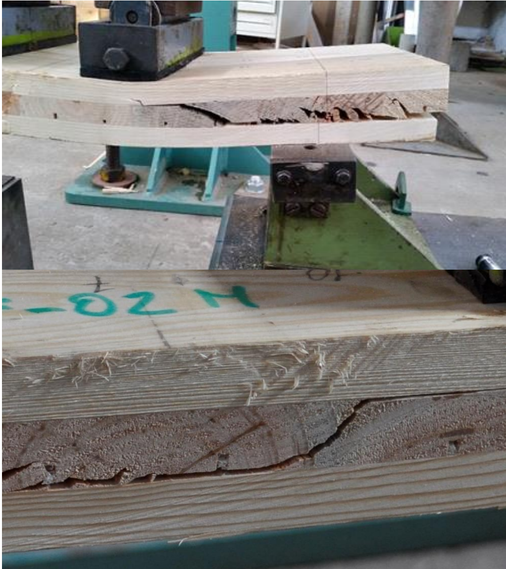
Figura 4.2.16 Esempi di rottura per rolling shear (pannello misto Abete-Pino Marittimo)
