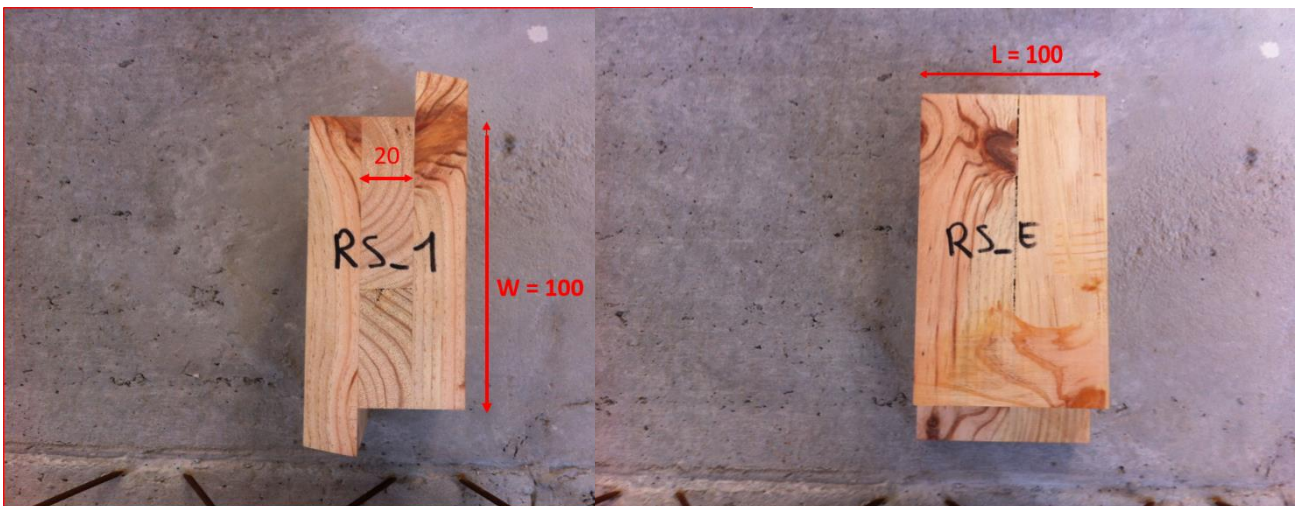
Figura 4.2.21 Dimensioni dei provini per la prova di taglio alternativa a rolling shear
