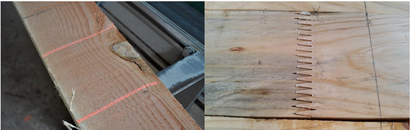
Figura 4.1.5 Individuazione del difetto (sinistra) giunto a dita (destra)
