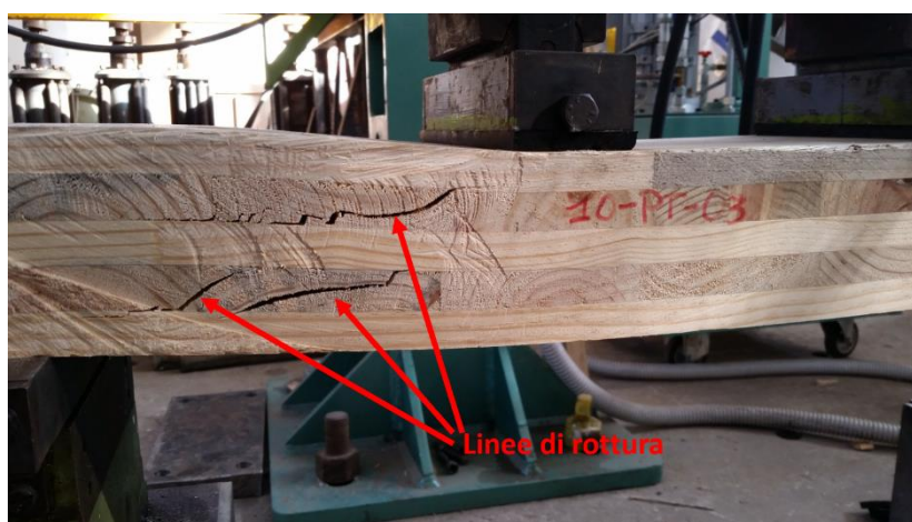
Figura 4.2.18 Esempio di rottura per rolling shear nei pannelli a 5 strati
