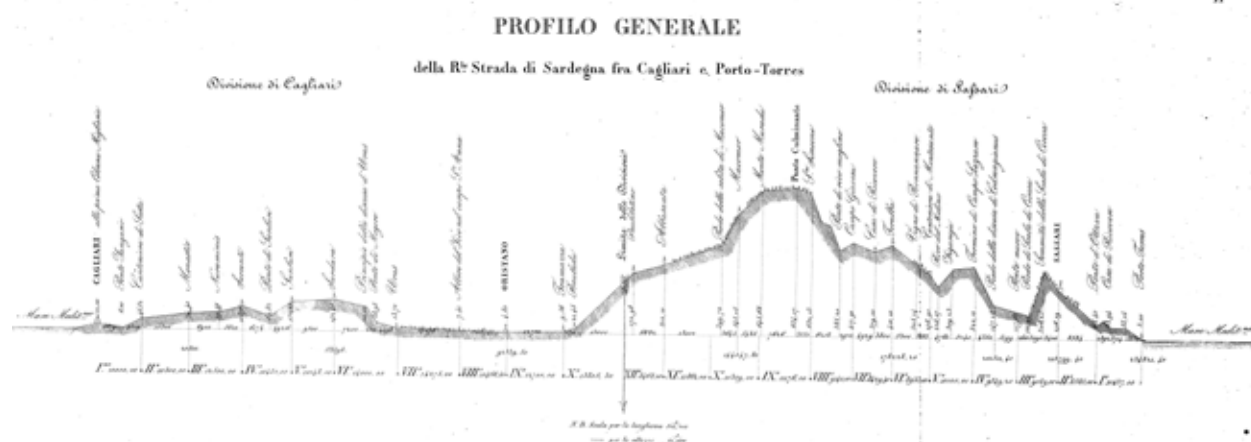
Profilo generale della strada Reale coll'indicazione dei punti principali sopra il livello del mare, della divisione dei tronchi, e delle distanze fra un punto e l'altro (CARBONAZZI, Sulle operazioni stradali , cit., Tav. II).
