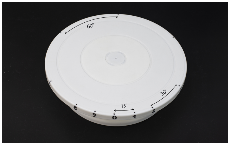
Figura 2. Rappresentazione del piattello rotante con il dettaglio dei punti in cui vengono eseguite le fotografie.
