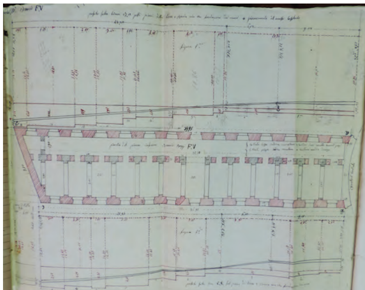
Fig. 9b - Elaborato di progetto del carcere di San Sebastiano a Sassari con indicazione dei materiali costruttivi e delle apparecchiature murarie da utilizzare (ASGC, Sassari, Carcere di San Sebastiano, Pianta . 30 maggio 1866).
