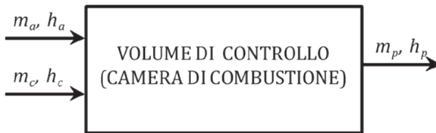
Figura 2.1.2. Schematizzazione di una camera di combustione adiabatica.
