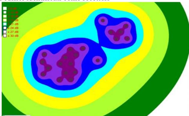
Figura 2 - ISO dB con il modello ISO 9613 nelle frequenze da 10 Hz a 160Hz.
