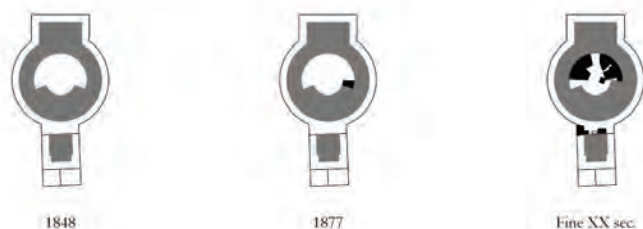
Fig. 8 - Tempio Pausania, ex carcere La Rotonda. Analisi cronologica delle strutture (elaborazione M. Corongiu, L. Demontis 2018; editing F. Musanti 2020).
