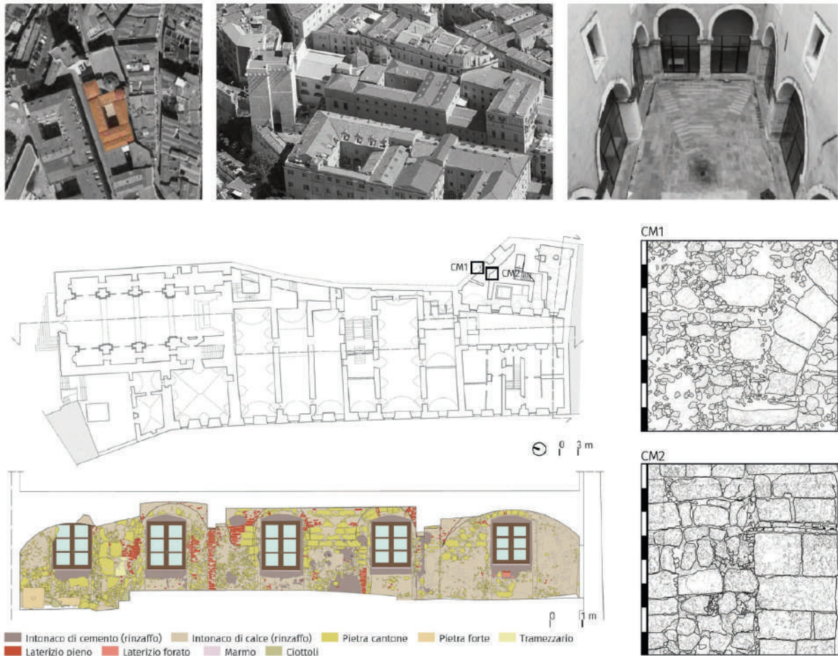
Fig. 6. CAGLIARI – Complesso collegiale di San Giuseppe Calasanzio: a) inquadramento urbano del sito; b) vista aerea; c) stato attuale del chiostro; d) planimetria con individuazione dei campioni murari; e) prospetto esemplificativo delle fasi costruttive; f) campioni murari investigati (elaborazione grafica M. Barrui, A. Murgia, E. Pilia, A. Tavera 2020).
