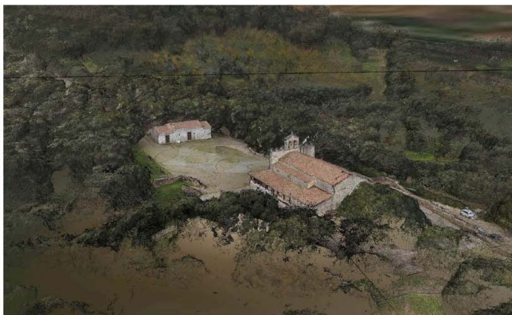
Fig. 5. Nuvola di punti densa realizzata dai frame di sequenze video con lo scopo di acquisire un contesto più ampio e progettare il rilievo. Elaborazioni di Nicola Paba, coordinamento scientifico Andrea Pirinu.
