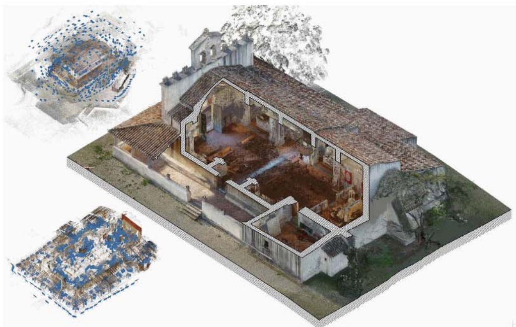
Fig. 7. Vista assonometrica delle nuvole di punti (esterno e interno) e restituzione dello spaccato assonometrico ottenuto a partire dal loro allineamento. Elaborazione di Nicola Paba, coordinamento scientifico Andrea Pirinu.
