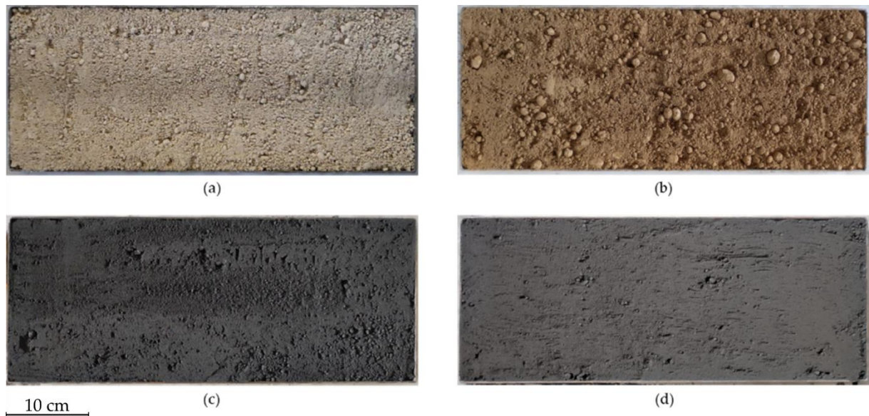
Figura 3.11. Esempi dei campioni collocati all'interno di vassoi di alluminio e testati nella galleria del vento: a) gesso GP; b) solfati BD; c) galena MS; d) blenda PR (Lai et al., 2025).
