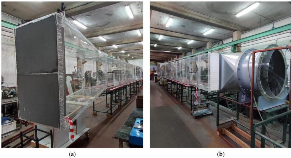
Figura 3.3. (a) Vista della galleria del vento DICAAR dalla sezione convergente (ingresso del flusso); (b) vista della galleria del vento DICAAR dalla sezione divergente (uscita del flusso) (Pinna et al., 2024).
