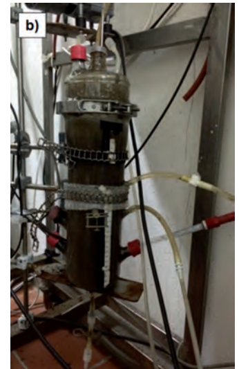
Figura 4 – Rappresentazione schematica dell'apparato sperimentale (a) e immagine del GSBR utilizzato nel corso della sperimentazione (b)
