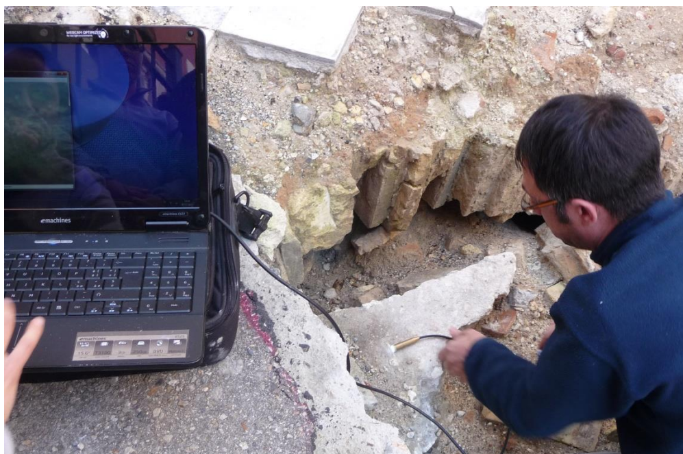
Fig. 51. Un membro del Gruppo Speleo Archeologico "Giovanni Spano" di Cagliari, indaga con una video camera montata su una fibra ottica l'interno di un locale ipogeo, oggi evidente al di sotto della sacrestia di sinistra, voltato in mattoni e colmato di sabbie e detriti; la volta è stata in parte demolita dalle benne del comune nell'agosto del 2002 insieme ad alcune pavimentazioni del presbiterio.
