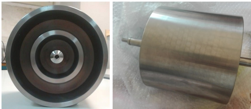
Figura 4.16. Immagini della parte centrale del rotore realizzata in acciaio AISI304
