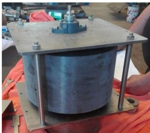
Figura 4.30. Posizionamento barre filettate e distanziali
