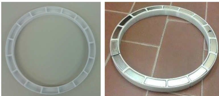
Figura 4.20. Sulla sinistra, alloggi magneti in policarbonato. Sulla destra, magneti disposti nell’alloggio in policarbonato
