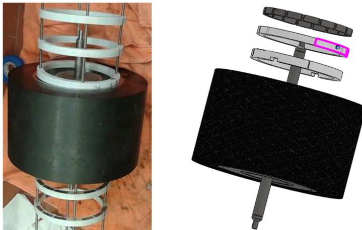
Figura 4.21. Assemblaggio alloggiamento magneti con la struttura in acciaio
