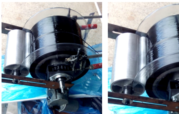
Figura 4.17. Sulla sinistra, avvolgimento della fibra usando il filament winding ed il wet lay-up . Sulla destra, dettaglio sulla ruota in contropinta che consente una miglior gestione della resina e una complessiva realizzazione dell'anello esterno.
