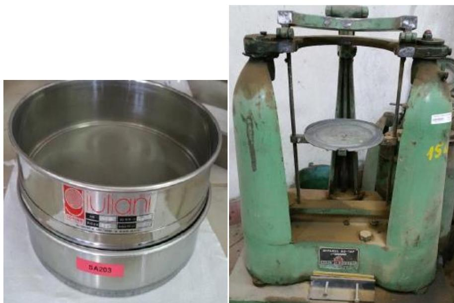
Figura 4.2. Setacci e RO-TAP utilizzati per la vagliatura del materiale
