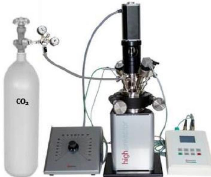
Figura 4.10. Reattore "highpreactor" con bombola di CO<sub>2</sub>
