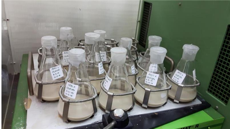
Figura 4.9. Campioni in beuta per test ANC
