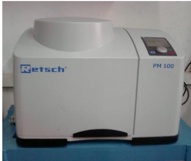
*Figura 4.4. Mulino a sfere Retsch PM 100*
