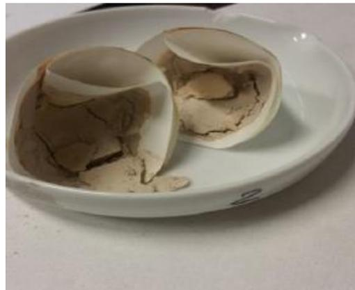
Figura 4.12. Campione slurry CDW essiccati
