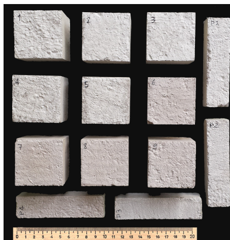
Fig. 4. Alcuni provini normalizzati realizzati in accordo con la composizione del campione originale e secondo le prescrizioni vitruviane.
