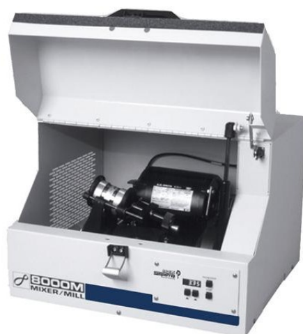
Fig. 5. Il mulino SPEX Mixer/Mill 8000 utilizzato nella sperimentazione.
