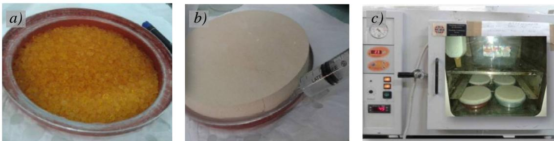
Fig. 5.5.1.1. Preparazione dei campioni per effettuare la prova di permeabilità al vapore acqueo. a) contenitore con gel di silice, b) posizionamento del campione sul contenitore in alluminio, c) campioni all'interno della stufa.
