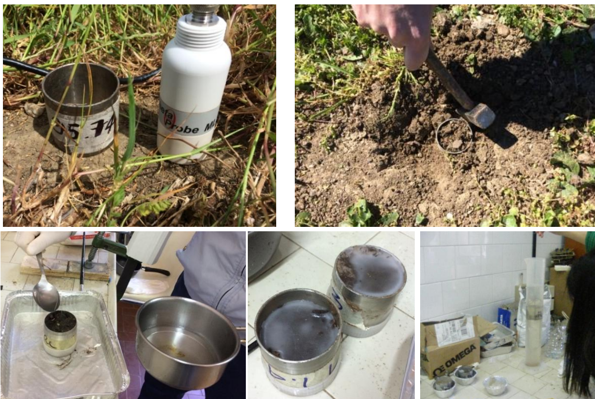
Figura 3.12. Misure gravimetriche, dal prelievo del campione al calcolo del volume in laboratorio
