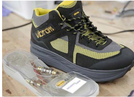
Figura 147: Prototipo di sistema indossabile ad accumulo di energia elettrica, integrato nella suola della scarpa denominato "Hero" [Vibram e InStep NanoPower].
