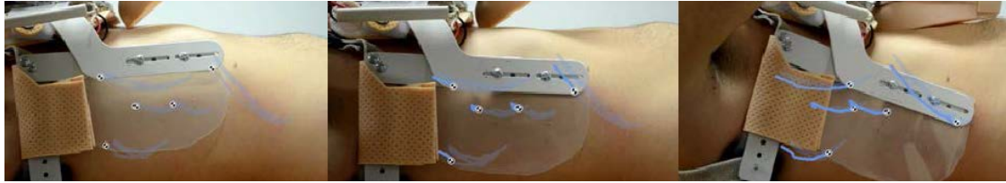
Figura 73: Scostamento elettrodi inferiori per movimenti improvvisi lungo il piano sagittale dell'individuo.
