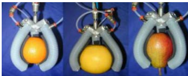
Figura 102: Mano di presa con tre dita flessibili ad attuazione pneumatica [31].
