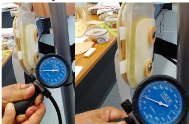
Figura 76: Fasi di gonfiaggio attuatore pneumatico.
