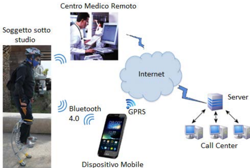
Figura 146: Schema di principio sistema metabolimetrico portatile mediante approccio IoT.
