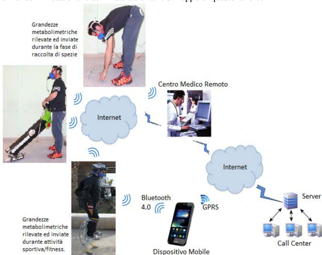
Figura 199: Schema di principio per invio e ricezione grandezze metaboliche.
