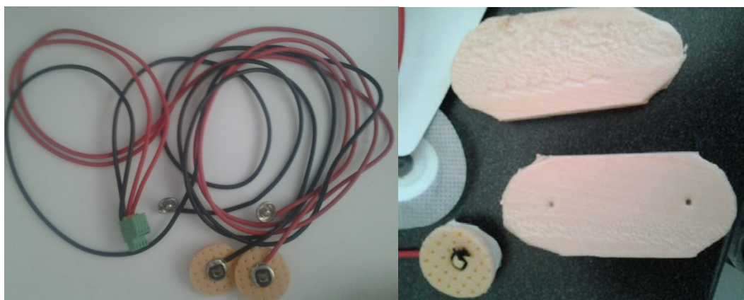
Figura 36: Configurazione reale elettrodi-bottoni automatici-cavi unipolari-morsettiera
