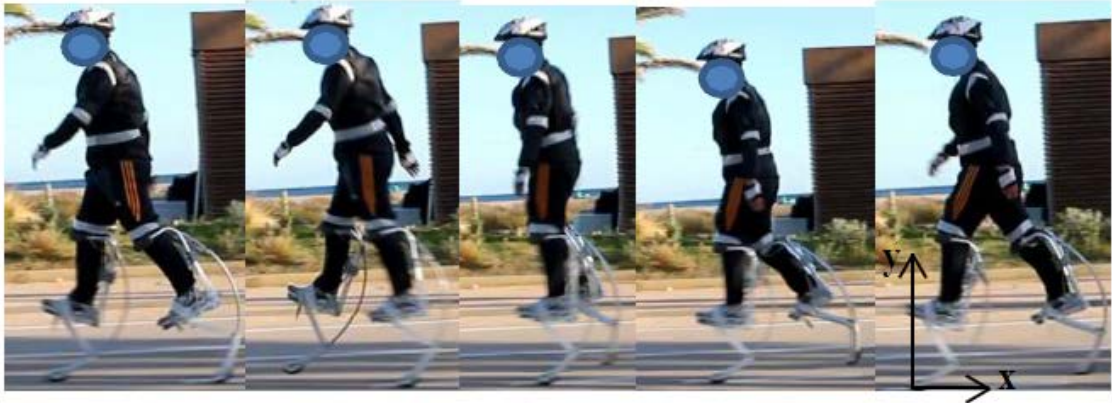
Figura 168: Fotogrammi analizzati (da destra verso sinistra) e sistema di riferimento solidale con lo zoccolo a terra.
