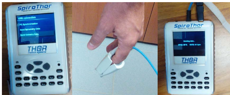
Figura 58: Sistema di acquisizione SpiroThor impostato come pulsiossimetro portatile
