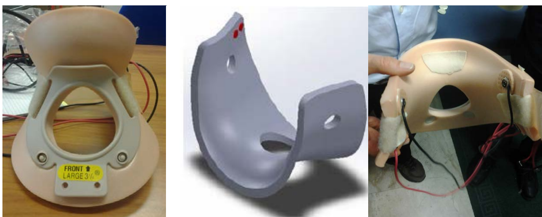
Figura 55: Parte frontale collare modello Philadelphia (modello 3D e supporto reale) con integrati elettrodi superiori e cavi.
