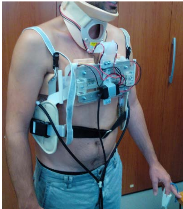
Figura 87: Acquisizione variabili emodinamiche tramite sistema di acquisizione impedenziometrico (UPC) e corpetto strumentato (UPV).
