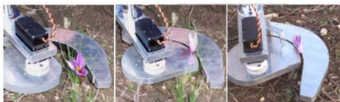
Figura 109: Fasi di distacco del fiore e funzionamento del prototipo sul campo [38].
