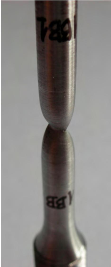
Figura 23 - Post-mortem con evidenza del necking ellittico in un provino a sezione circolare.
