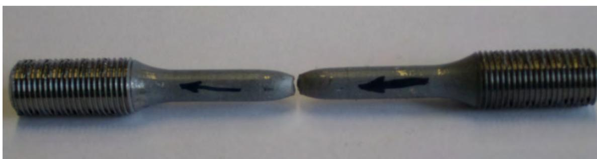
Figura 22 - Necking di un provino a sezione circolare. Post-mortem dopo una prova di trazione monoassiale
