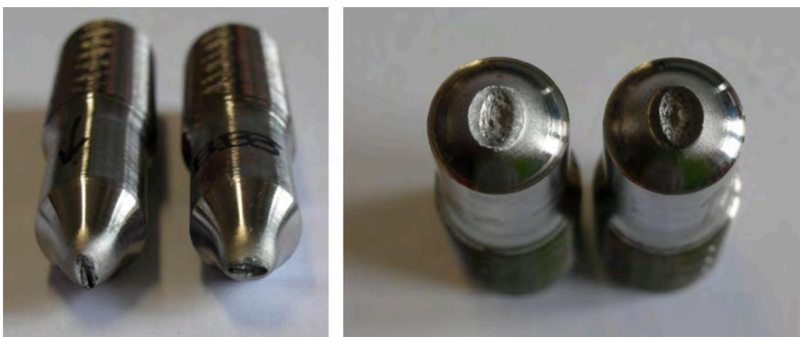
Figura 20, 21 - Superfici di frattura di due provini. RNB10 (sinistra) ed RNB2 (destra)
