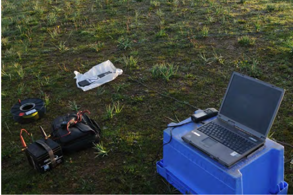
Photo 10 : Instrument TEM-Fast48 complet avec ses composants
