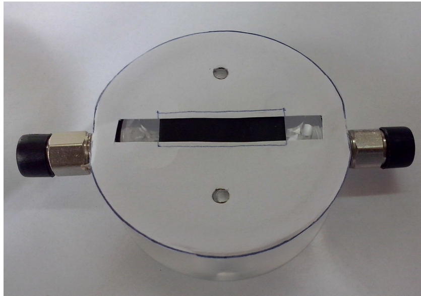
Figura 4.3.2 Reattore a flusso. Disco distanziale.
