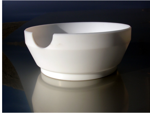
Figura 3.2.4 Uno dei due seggi semisferici in Teflon utilizzati come tenuta della sfera.
