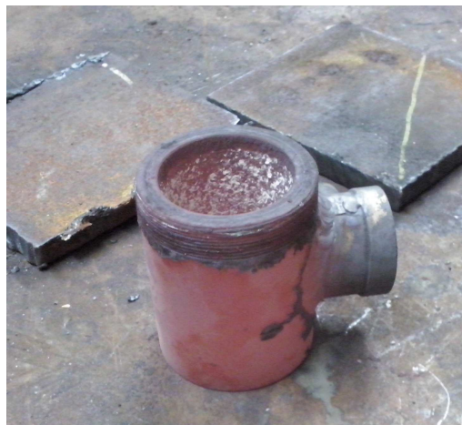
Figura 3.2.5. Giara dopo il rinvenimento seguito alla saldatura.
