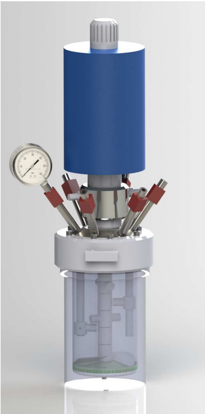
Figura 3.3.1.1 Attritore. Vista in configurazione di lavoro.
