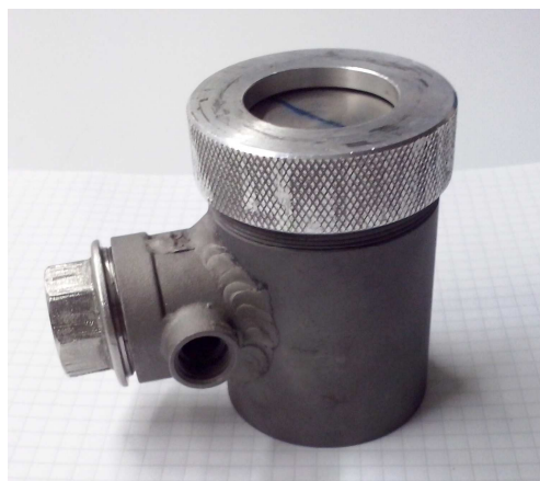
Figura 3.2.6 Giara con valvola a tre vie.
