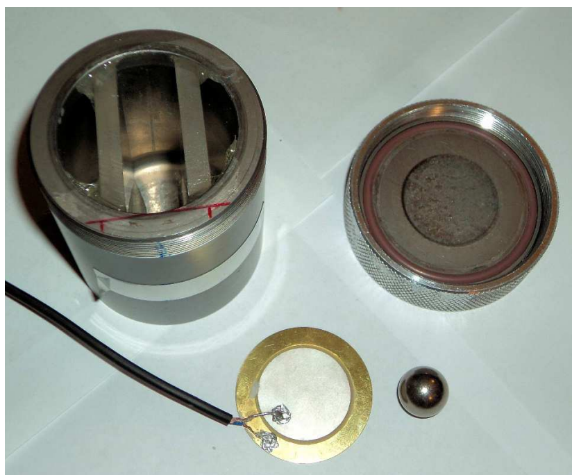
Figura 3.1.5.1 Reattore aperto. Si notano i due setti in policarbonato inseriti nel corpo del cilindro ed il sensore sismico separato dal fondo della giara.
