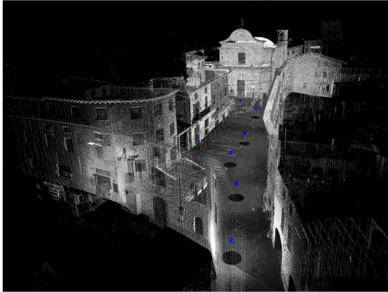
Fig. 28 – Esempio di nuvola di punti tridimensionale – Rilievo della Chiesa di San Giovanni Decollato - Manerba Del Garda (BS) – Studio R.T.C., Cremona 95
