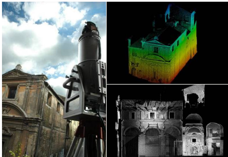
Fig. 24 – Esempio di utilizzo del laser-scanner per il rilievo dell'esistente 92
