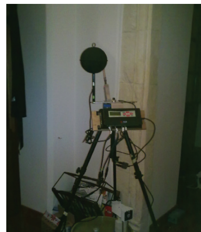
Fig. 74: Misura delle caratteristiche dell'ambiente interno: stazione microclimatica.
