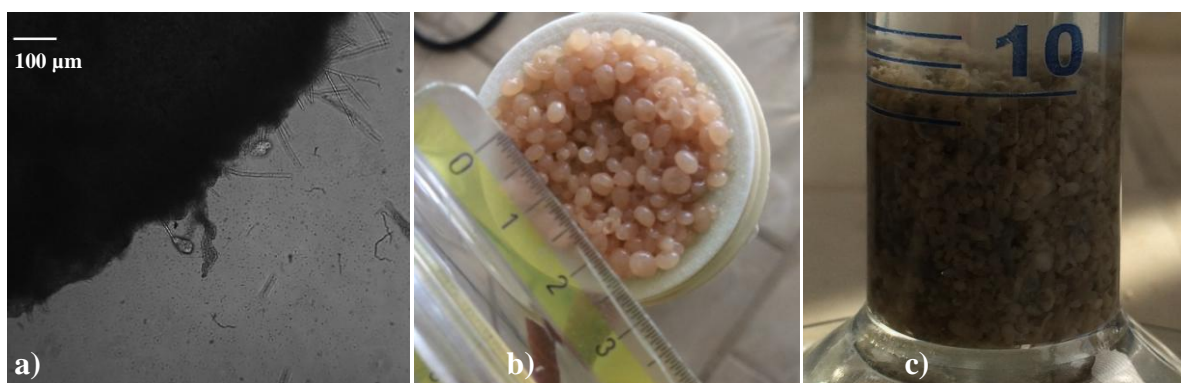
Figura 5.4 Superficie di un granulo aerobico al microscopio a contrasto di fase (a) e granuli aerobici osservati nel GSBR-A il giorno 173 (b) e 265 (c).
