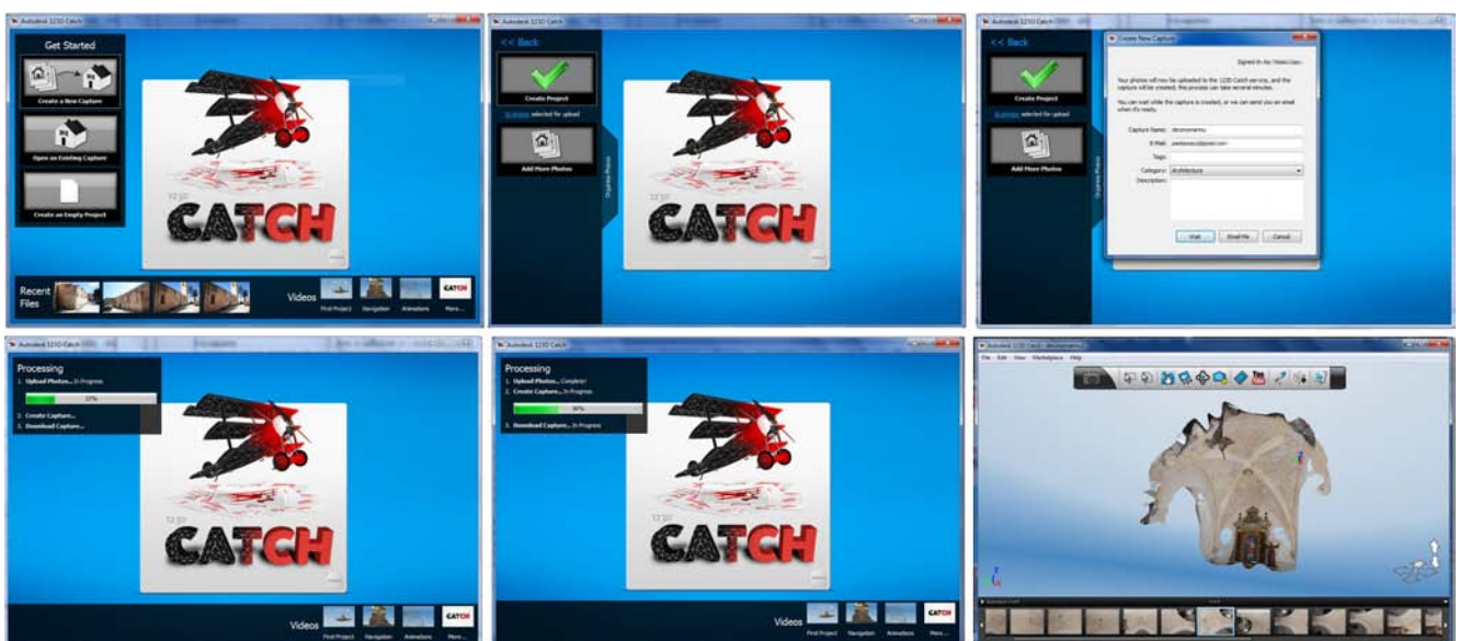
Fig.9 - Sequenza delle schermate di 123D Catch. Da sinistra a destra, dall'alto in basso: avvio del software, selezione delle immagini, richiesta di nuovo progetto al web-service, upload delle immagini, elaborazione delle immagini, download del risultato.
