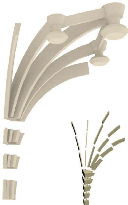
Fig.22 - Esploso assonometrico dei conci costituenti uno spicchio di volta. Conci di avvio, nervature principali e secondarie, chiavi e nervature di collegamento.
