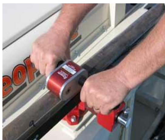
Figura 5.3: Sistema di campionamento in continuo ed indisturbato Geoprobe DT32.
