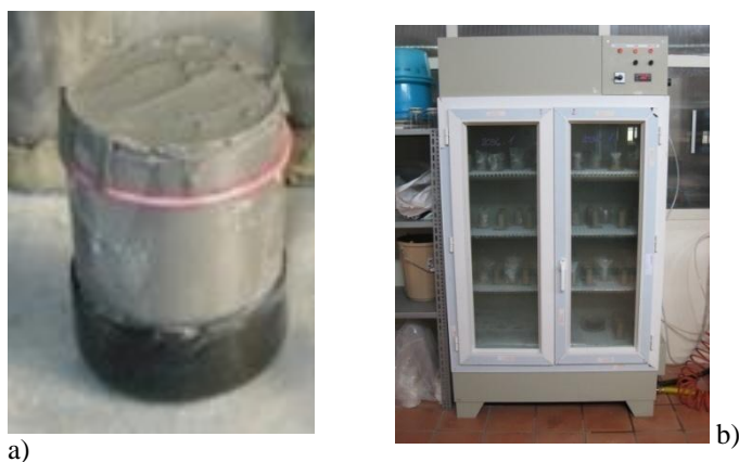
Figura 7.1: a) provino cilindrico subito dopo il confezionamento della miscela; b) camera termostatica.
