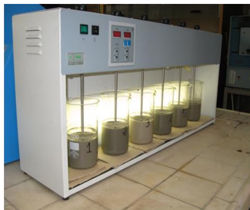
Figura 6.2: dispositivo di agitazione utilizzato per le prove di stabilizzazione.
