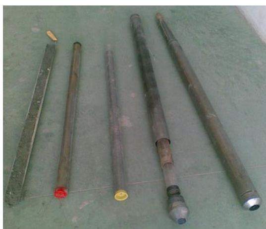
Figura 5.3: Sistema di campionamento in continuo ed indisturbato Geoprobe DT32.
