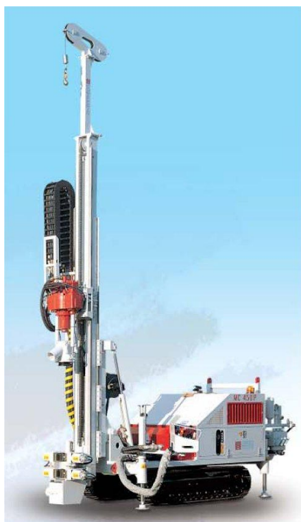
Figura 5.2: Perforatrice idraulica Comacchio MC 450 P1 impiegata per la campionatura.
