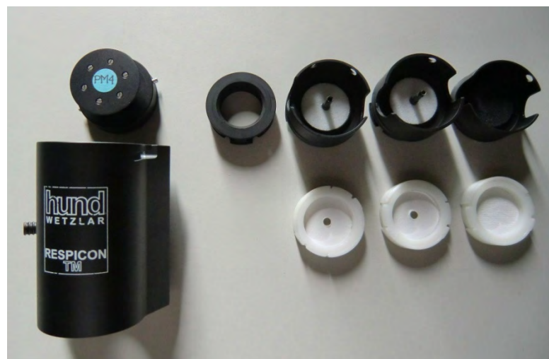
Figura 4.2: Impattore multistadio Respicon TM
