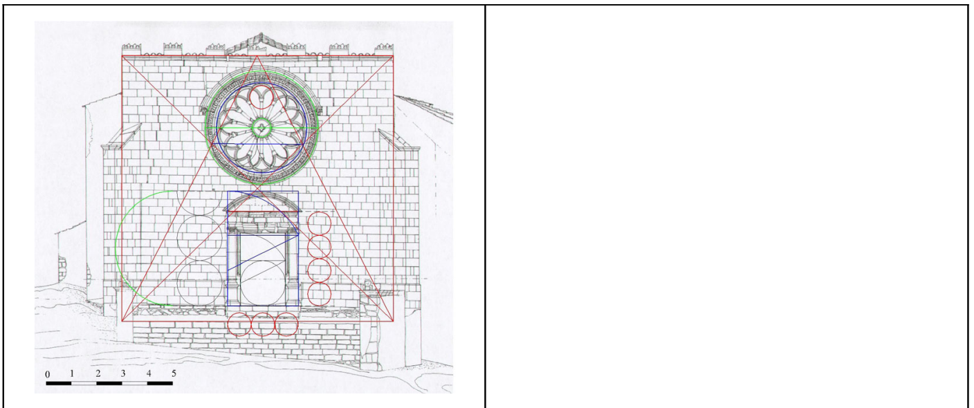
Fig. 1 - Analisi geometrico dimensionale della facciata
