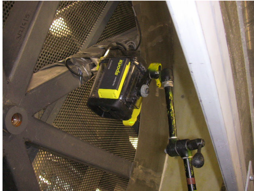
Figura 68 – Telecamera di precisione per la misura della velocità degli strati superficiali
