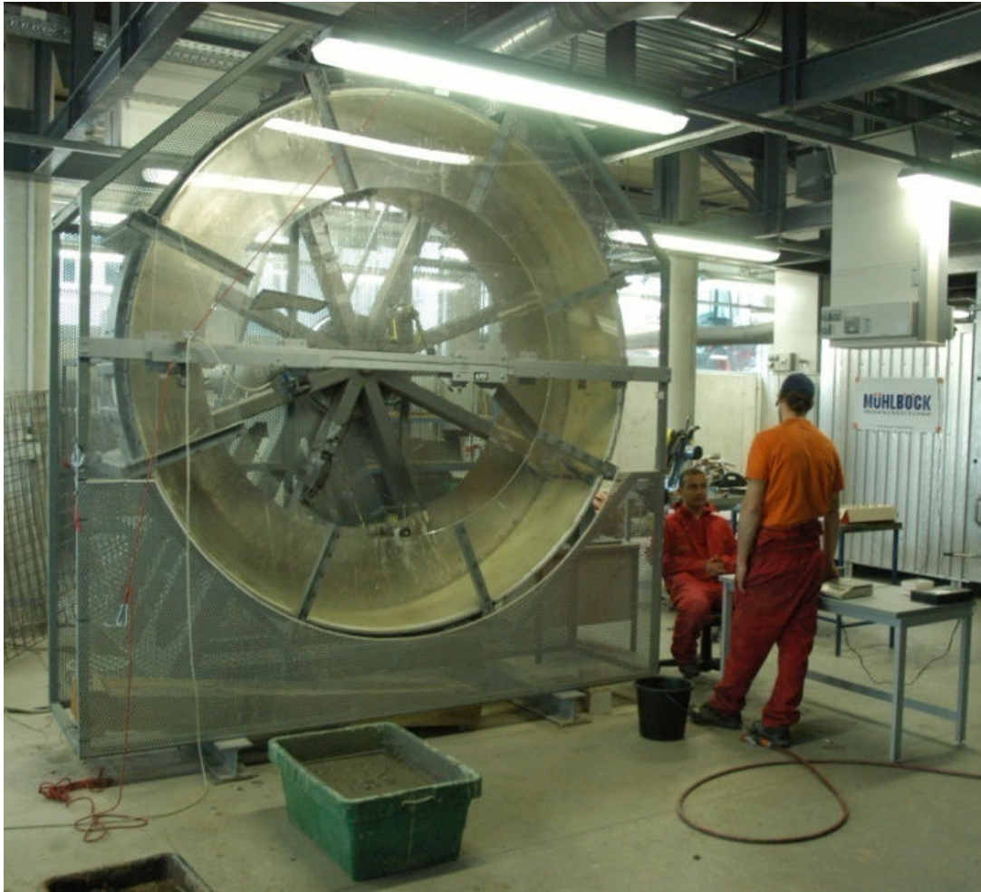
Figura 62 – Preparazione dei campioni da inserire nel canale rotante verticale
