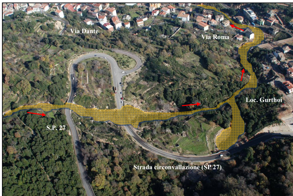
Figura 27 – Vista da elicottero del tratto del rio s'Arrescottu interessato dal debris-flow presso l'abitato di Villagrande (campionatura gialla)
