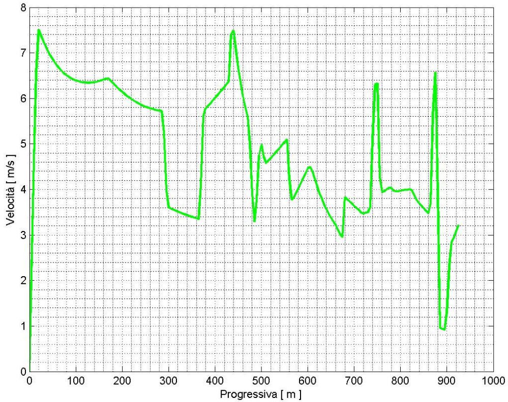
Figura 95 – Velocità della colata detritica lungo l’asta del Rio S’Arrescottu Calibrazione del modello-back analysis evento 2004
