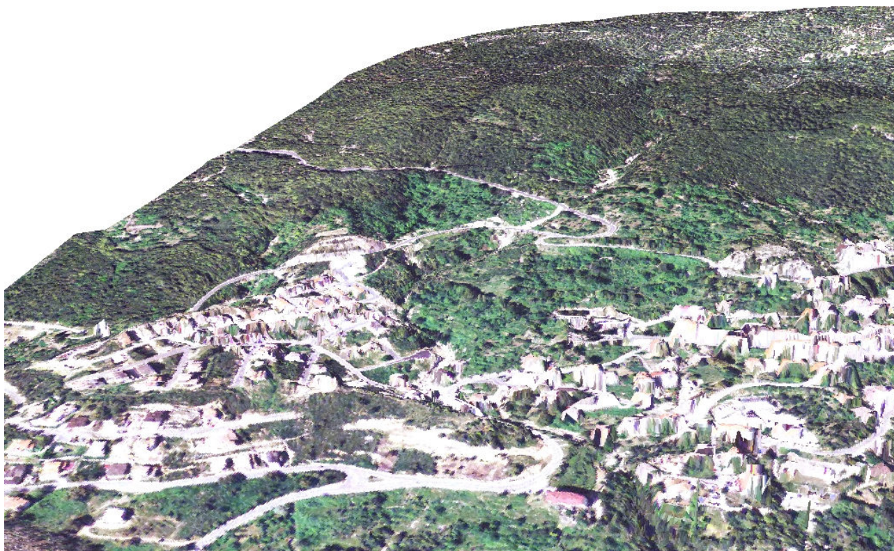
Figura 91 Rappresentazione digitale del terreno ottenuta per il bacino del rio S'Arrescottu
