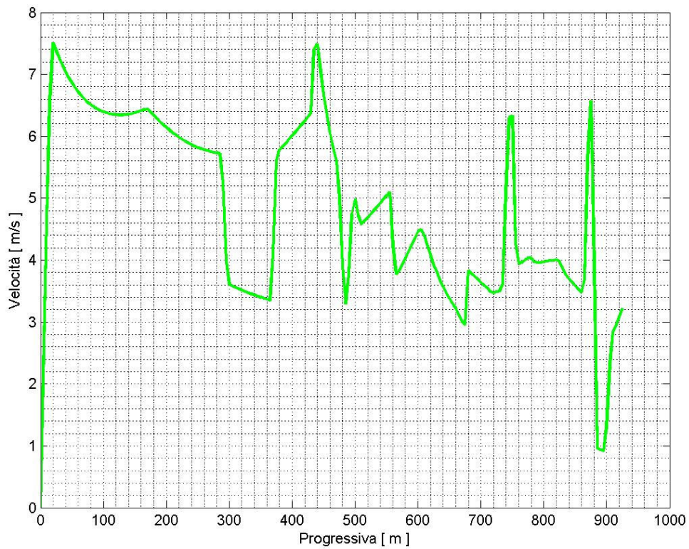
Figura 117 – Velocità della colata detritica lungo l’asta del Rio S’Arrescottu. Risultati della calibrazione del modello – back analysis evento 2004
