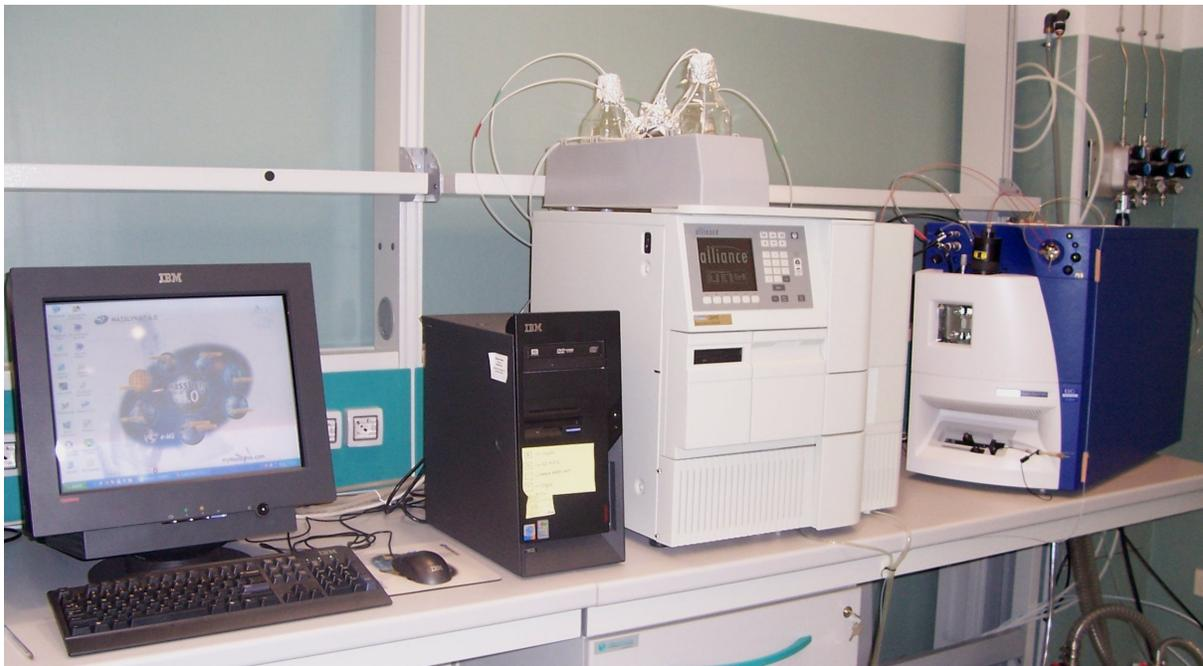
Figura.22 Sistema LC/MS Water Alliance 2696 HPLC accoppiato allo Spettrometro di Massa, Waters MicroMass Q-micro.
