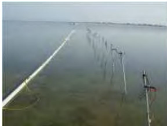
Fig. 5.3: Vista dello stendimento e degli elettrodi
