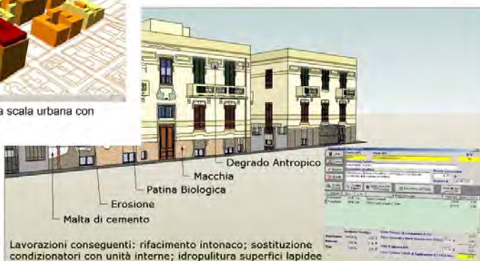
Figura 2. Reggio Calabria. "Quartiere Latino". Isolato Urbano 78. Particella Catastale 97. 3D architettonico. Analisi dei degradi rilevabili, localizzazione spaziale delle consigliabili Lavorazioni, con annesso DBMS che ne quantifica i fattori elementari e i costi
