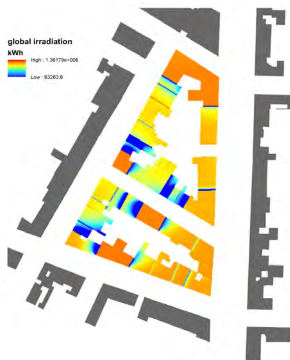
Fig. n°9.16, Raster dell'irraggiamento solare annuo in kWh
