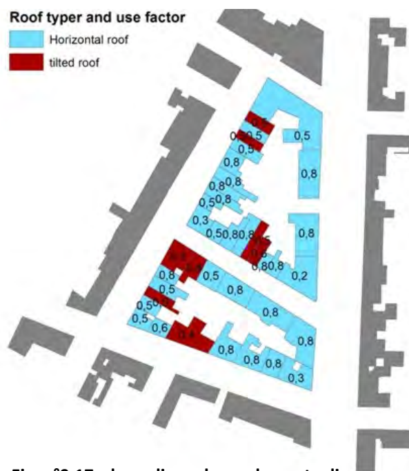
Fig. n°9.17, shp poligonale con la quota di superficie di copertura utilizzabile per gli impianti.
