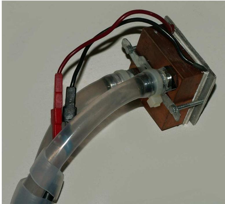
Figura 7.3: Modulo di iniezione dell'onda termica
