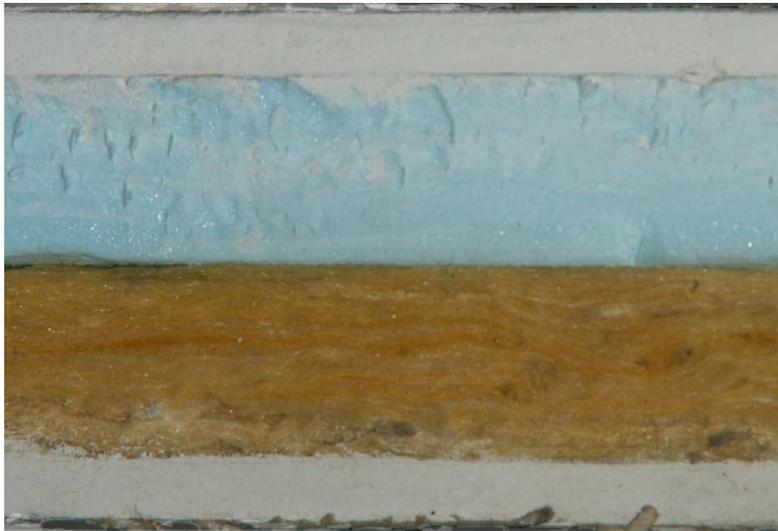
Figura 7.6: Vista in sezione dei materiali che costituiscono il modello
