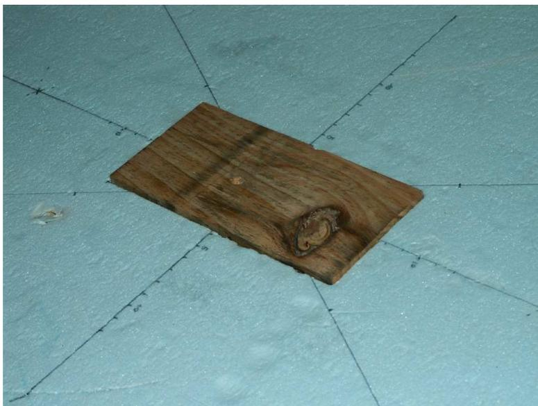
Figura 7.9: Dettaglio della nicchia contenente un provino di legno
