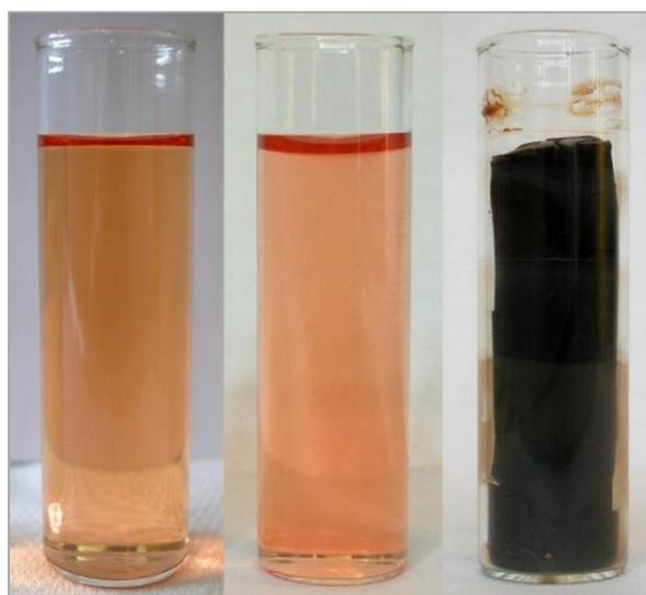
**Fig. 1.9 - Immagini del sol (sinistra), alcolgel (centro), ed aerogel dopo estrazione (destra).**
