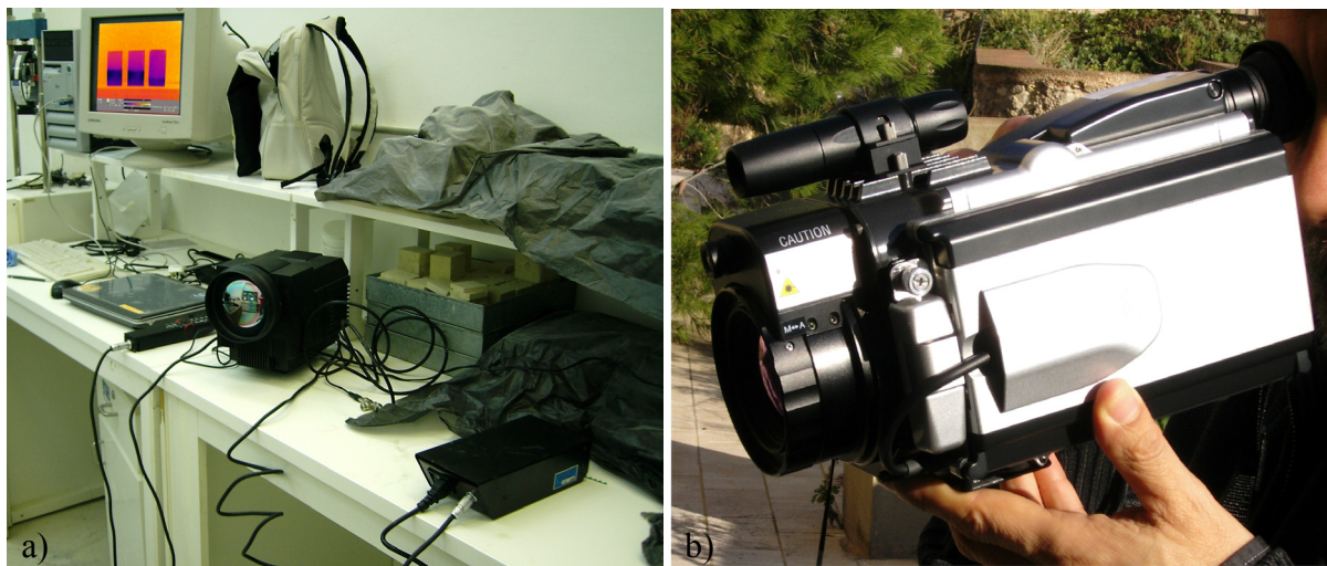
Figura 1.5: Due apparecchiature termografiche utilizzate in questa ricerca (a) termocamera con sensore raffreddato a ciclo chiuso Stirling; (b) termocamera con sensore microbolometrico non raffreddato.
