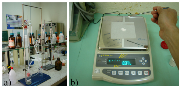
Figura 2.13: (a) Calcimetro di Dietrich-Frühling usato per la determinazione dei carbonati; (b) campione polverizzato in fase di pesatura con bilancia elettronica di precisione.
