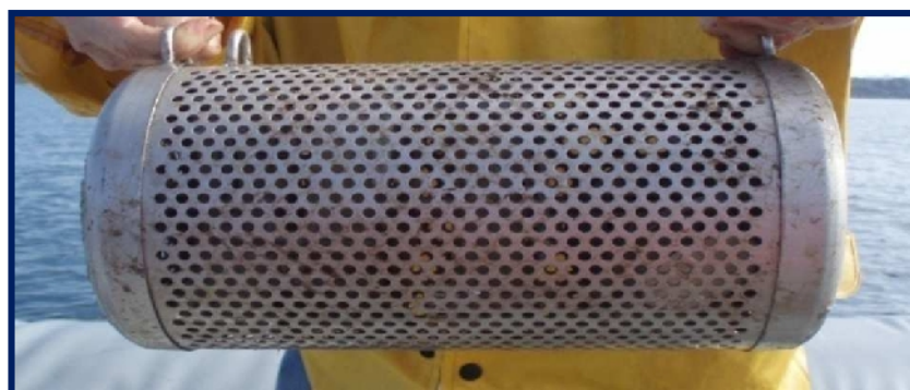
Fig. 3 – SPMD assemblato in un canister.
