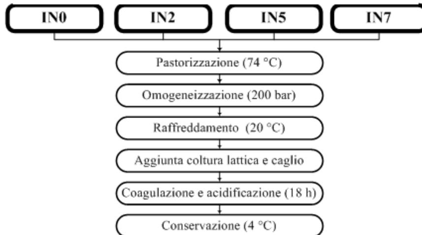
**Figura 6.2** – Schema di preparazione del formaggio
