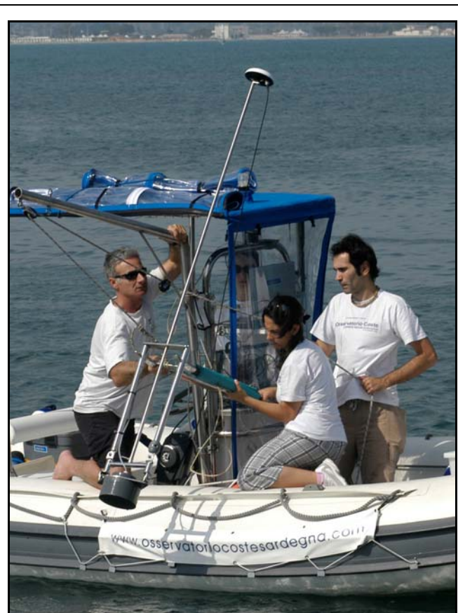
Fig. 89 - Strumentazione dell'imbarcazione OCEANS: in alto computer con software di navigazione PDS2000 interfacciato con DGPS Omnistar 8300HP ed Ecografo Navisound 215. A lato particolare del trasduttore dell'ecografo Navisound 215 con montata in asse antenna DGPS (Foto G.P.Dore).
