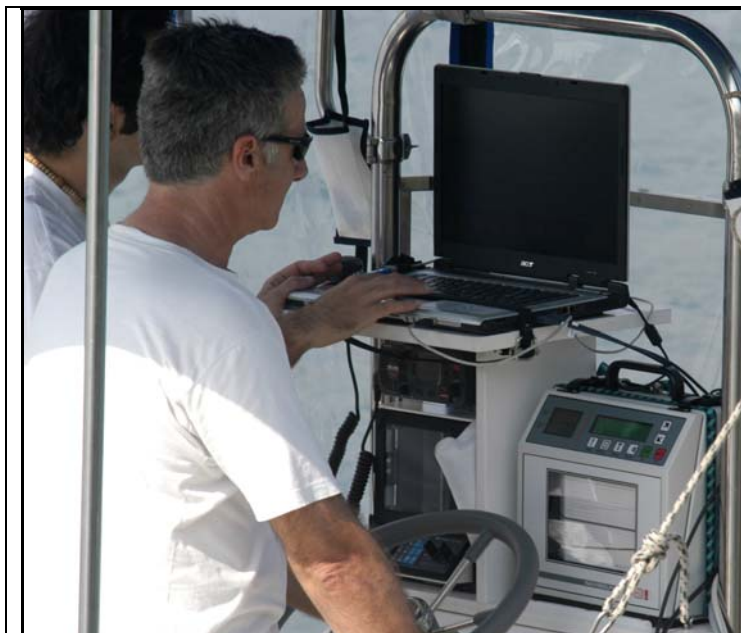
Fig. 89 - Strumentazione dell'imbarcazione OCEANS: in alto computer con software di navigazione PDS2000 interfacciato con DGPS Omnistar 8300HP ed Ecografo Navisound 215. A lato particolare del trasduttore dell'ecografo Navisound 215 con montata in asse antenna DGPS (Foto G.P.Dore).
