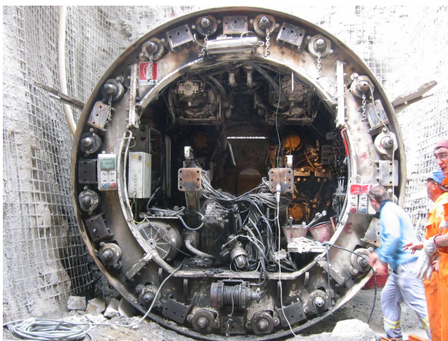
Figura 64 a: Scudo stazionario e ( a destra ) e scudo anteriore con piastra motori ( a sinistra).
