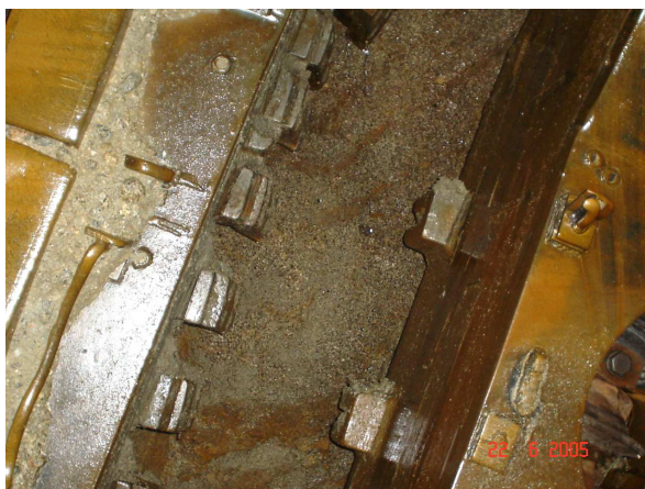
Figura 50: Particolare degli utensili montati sulla testa di taglio
