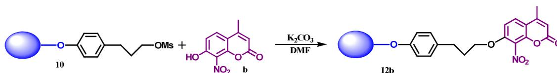
Il composto **10** (1.56 g, 0,3 mmoli) viene portato a fusione in un bagno d' olio a 100° C per circa un ora, sotto agitazione e sotto vuoto. Si aggiunge poi la DMF (8 ml), il carbonato di potassio (0.033 g, 0.6 mmoli) ed infine il composto **b** (0.13 g, 0.6 mmoli).
