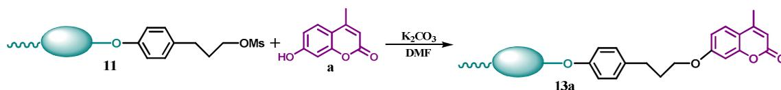
Il composto **11** (3.20 g, 0.63 mmoli) viene portato a fusione in un bagno d'olio a 100° C per circa un ora, sotto agitazione e sotto vuoto. Si aggiunge poi la DMF (15 ml), il carbonato di potassio (0.35 g, 2.52 mmoli) e infine il composto **a** (0.55 g, 3.15 mmoli).
