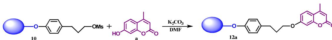
Il composto **10** (1 g, 0,12 mmoli) viene portato a fusione in un bagno d' olio a 100° C per circa un ora, sotto agitazione e sotto vuoto. Si aggiunge poi la DMF (5 ml), il carbonato di potassio (0.066 g, 0.48 mmoli) ed infine il composto **a** (0.106 g, 0.6 mmoli).
