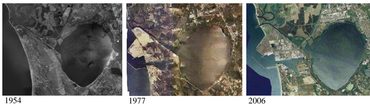
Figura 4.9. Ortofoto del 1954, 1977 e 2006 raffiguranti le trasformazioni conseguenti alla costruzione del Porto industriale di Oristano.
