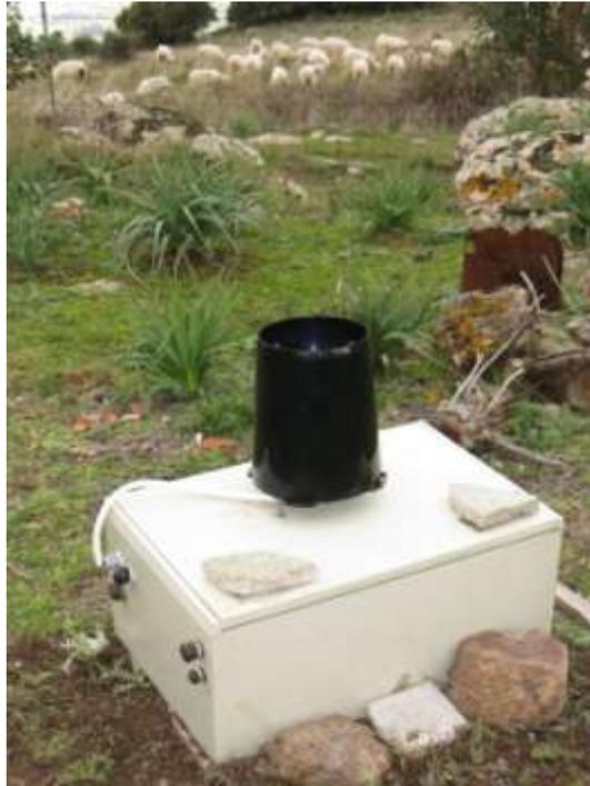
Figura 52 Pluviometro installato in campo
