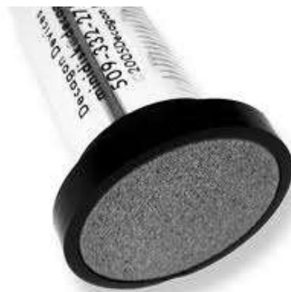
**Figura 70** Membrana semipermeabile di materiale ceramico del mini infiltrometro che viene posizionata a contatto del terreno
