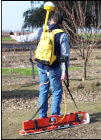
Fig. 12: EM38DD trasportato a mano
