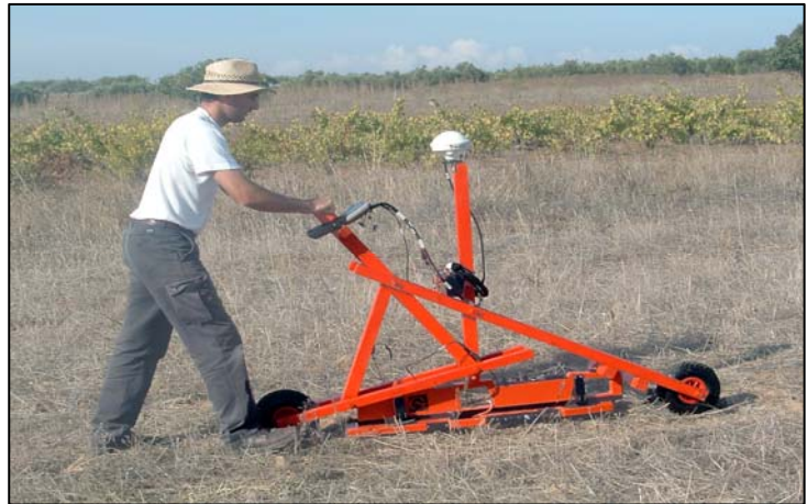
Fig. 13: EM38DD trasportato con apposito mezzo
