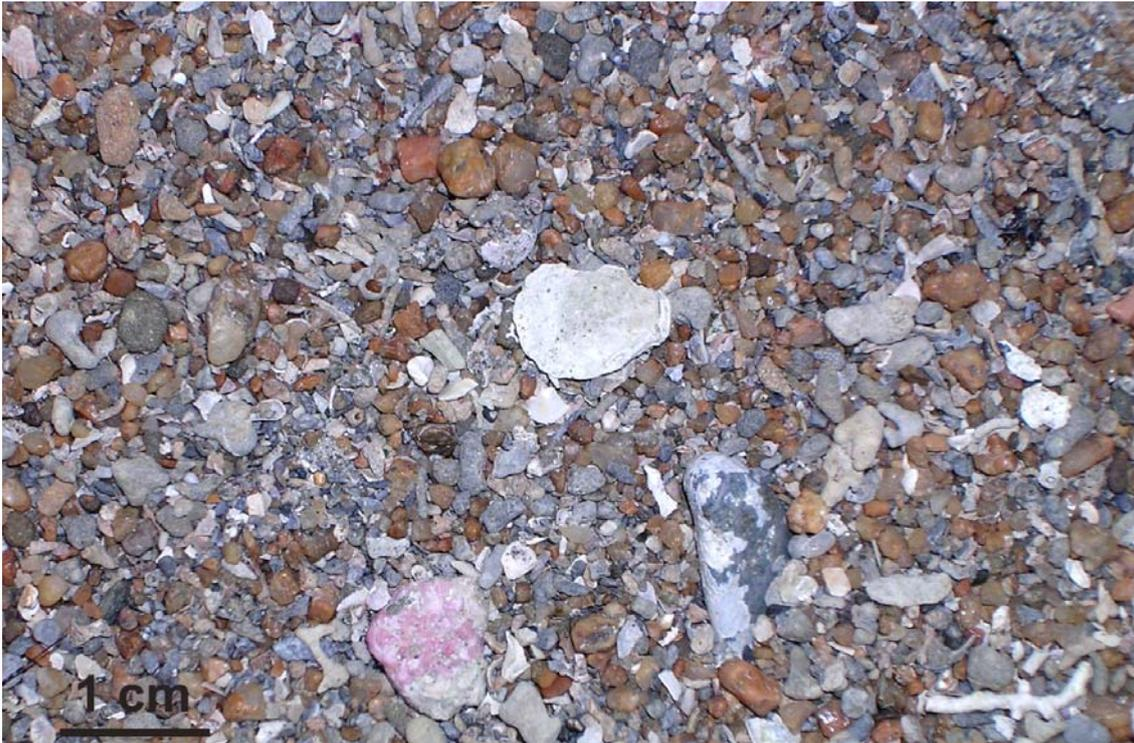
Fig. 9. Campione misto terrigeno-bioclastico SW1. Alle sabbie grosse e ghiaie silicoclastiche (K-feldspato, litoclasti e in misura minore quarzo) si associa una componente bioclastica ad alghe rossee e bivalvi.
