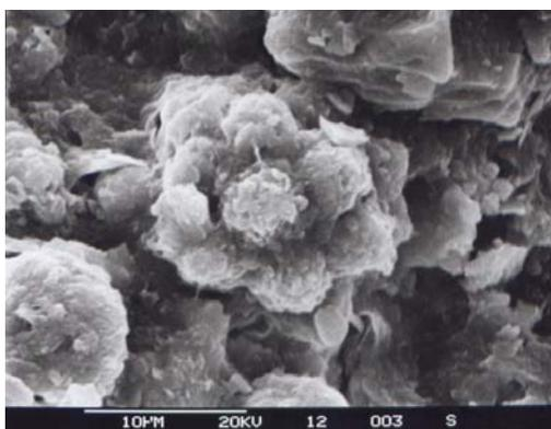
Fig. 2. Cristallo di calcite in un campione fangoso della piattaforma interna.
