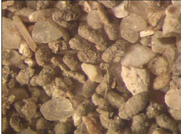
Fig. 2. Frazione delle sabbie medie ( $500 \div 250 \mu\text{m}$ ) del Campione T7C5 con *fecal pellets*, quarzo e frammenti bioclastici.
