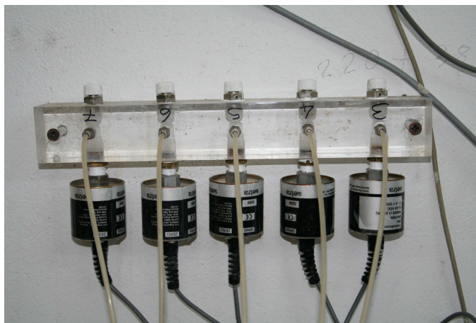
Figura 6.7: Trasduttori di pressione per la misura della pressione neutra.
