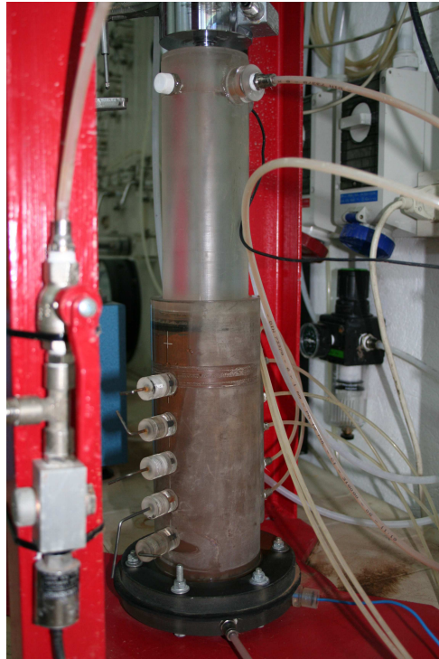
Figura 6.5: Cella elettrosmotica a volume variabile.
