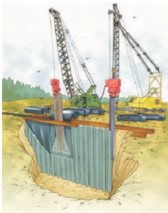
Figura 3.3: Schema esecutivo dello schermo sottile con membrana in HDPE eseguito senza asportazione di terreno
