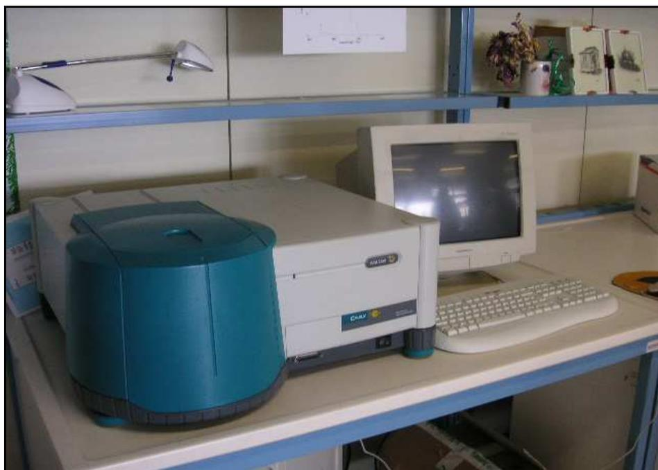
Figura 7: Spettrofotometro di fluorescenza Cary Eclipse
